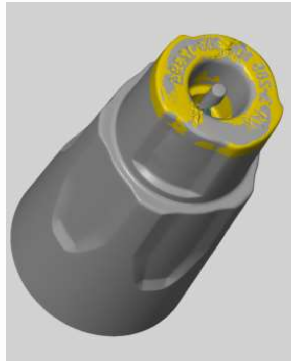
Polygonální síť po úpravě a zarovnání (STL)
