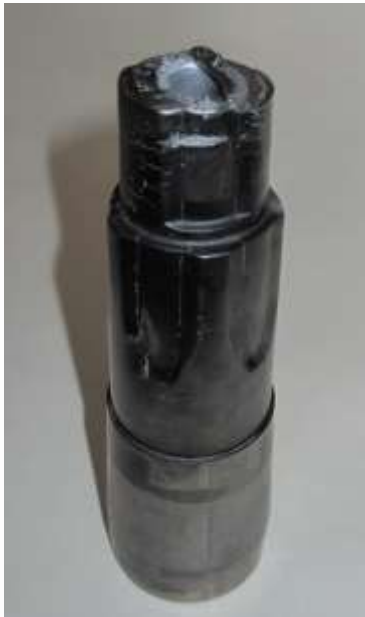
Jádro formy (nemožnost naskenovat – poškozeno)
