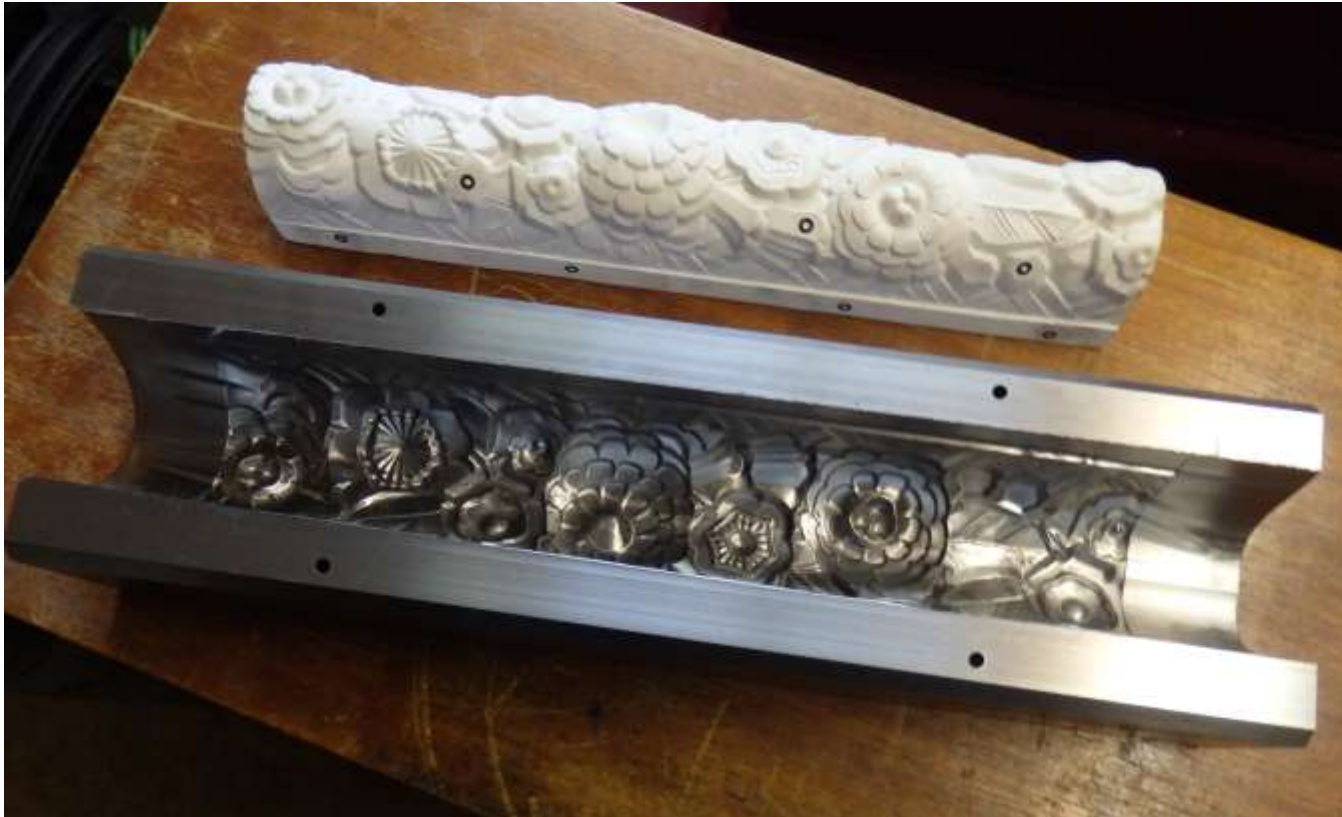
Sádrový model vs. kovová forma
