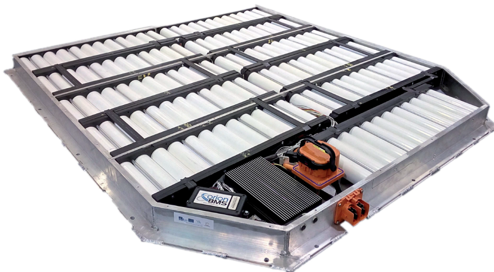
Obrázek 3.6: Funkční vzorek trakční baterie vozu Gen2
