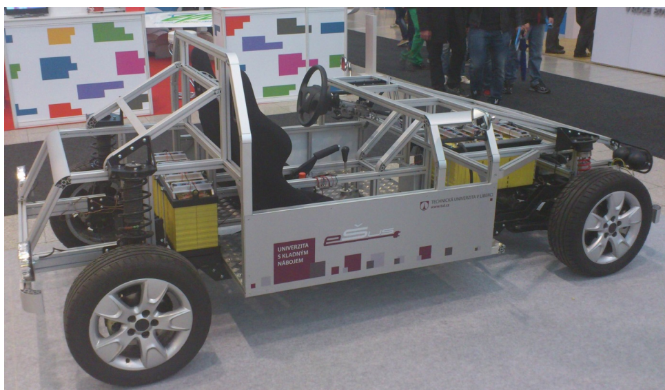
Obrázek 3.2: Funkční vzorek elektromobilu TUL, představený na MSV Brno 2013
