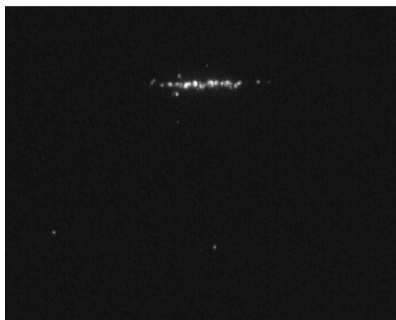
Obr. 13: Snímek z koronakamery - nástup korony na zkoumaném zařízení při U = 8 kV.
