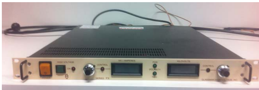
Obr. 2: Vysokonapěťový stejnosměrný zdroj Glassman FX
