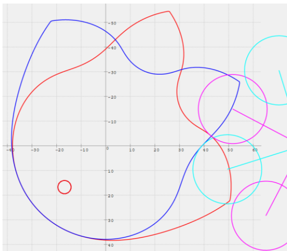
Obr. 4.6 Složená radiální symetrická dvojvačka
