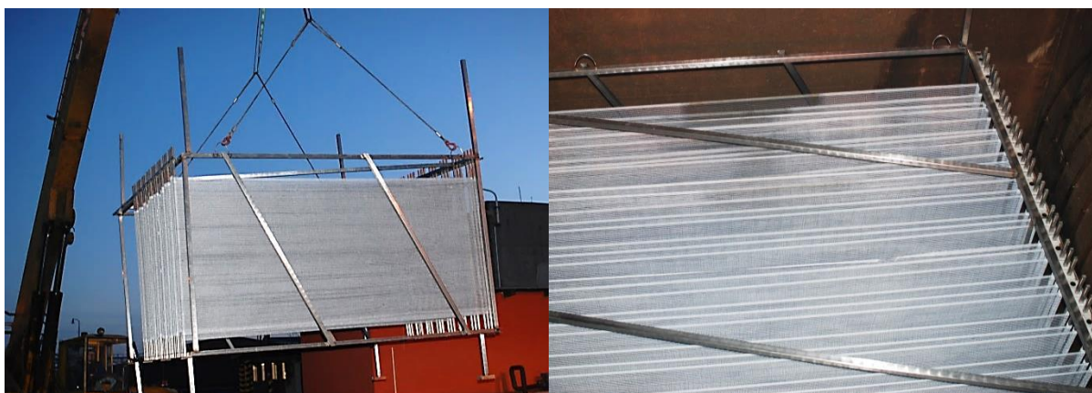
Obrázek 9 – Reálná konstrukce technologie vyjímatelných rámců (Lederer, 2011)
