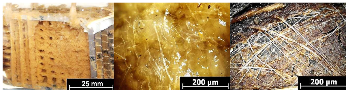
Obrázek 12 – Biofilm na vyjímatelných nosných rámech, detail biofilmu v mokřém a suchém stavu (pro reálné odpadní vody zatížené chloraminem B v laboratorních podmínkách)
