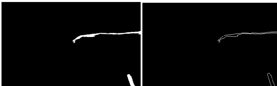
Obr. 10: Zaostrěný, prahovaný a skeletovaný obraz objektu
