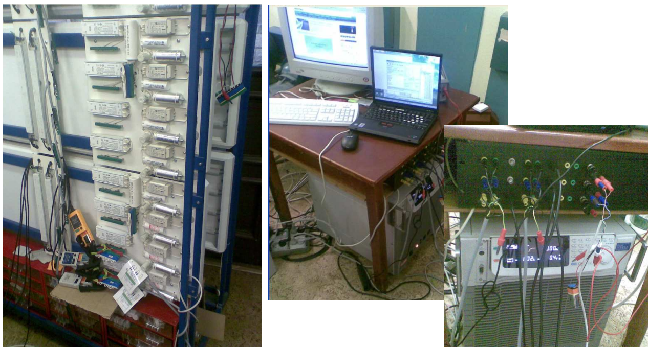
Obrázek 4.1: Vlevo model osvětlovací sítě, uprostřed měřicí pracoviště – EMU-2, vpravo výkonový zdroj PRC 2000LA
