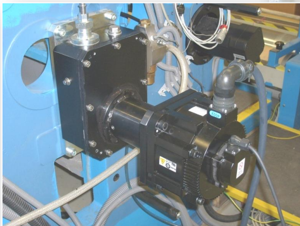
Obr.3.7 Aplikace elektronické vačky Yaskawa na tkacím stroji CAMEL W (pohon mechanismu vodního čerpadla)
