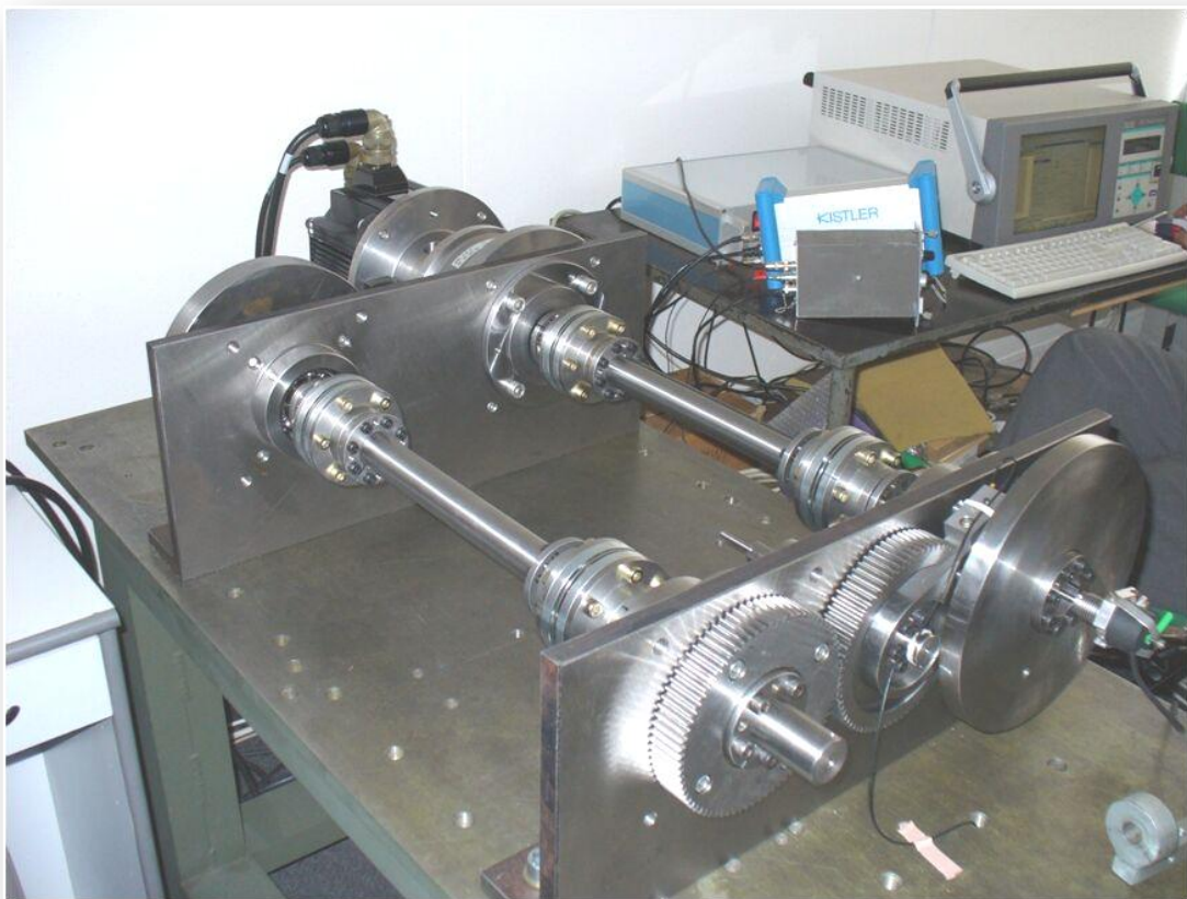
Obr.3.1 Stand klasického vačkového mechanismu (radiální vačka s vahadlem)
