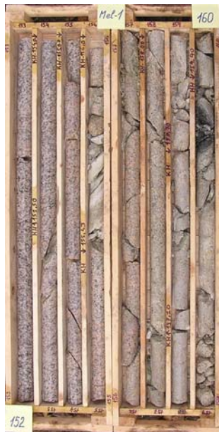
Obrázek 3.3.3: Jádro vrtu Mel-1 v místě poruchové zóny k=4,5*10^{-9} m.s^{-1} .
