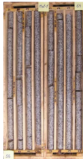
Obrázek 3.3.4: Jádro vrtu Mel-1 v místě s nejvyšší zjištěnou hydraulickou vodivostí k=4,5*10^{-6} m.s^{-1} .
