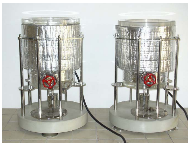
Obrázek 13: Instalace topných těles na nádoby fermentorů
