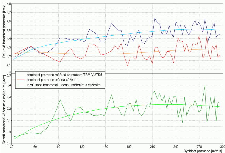
Obr.6 Vliv rychlosti na měřenou hodnotu délkové hmotnosti mykaného pramene v porovnání se skutečnou hmotností zjišťovanou vážením úseků.
