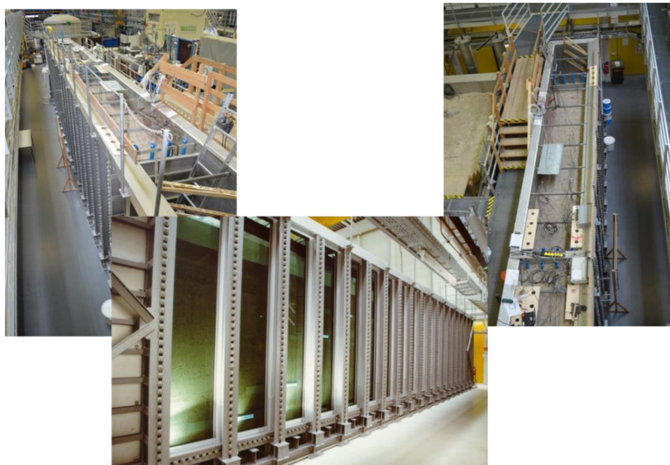
Obrázek 5: 3-D experimentální box ve výzkumném centru VEGAS (16 m x 1 m x 3 m (D x Š x V))
