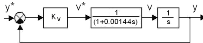
Obr. 4-1 – Blokové zapojení regulační struktury polohové smyčky
