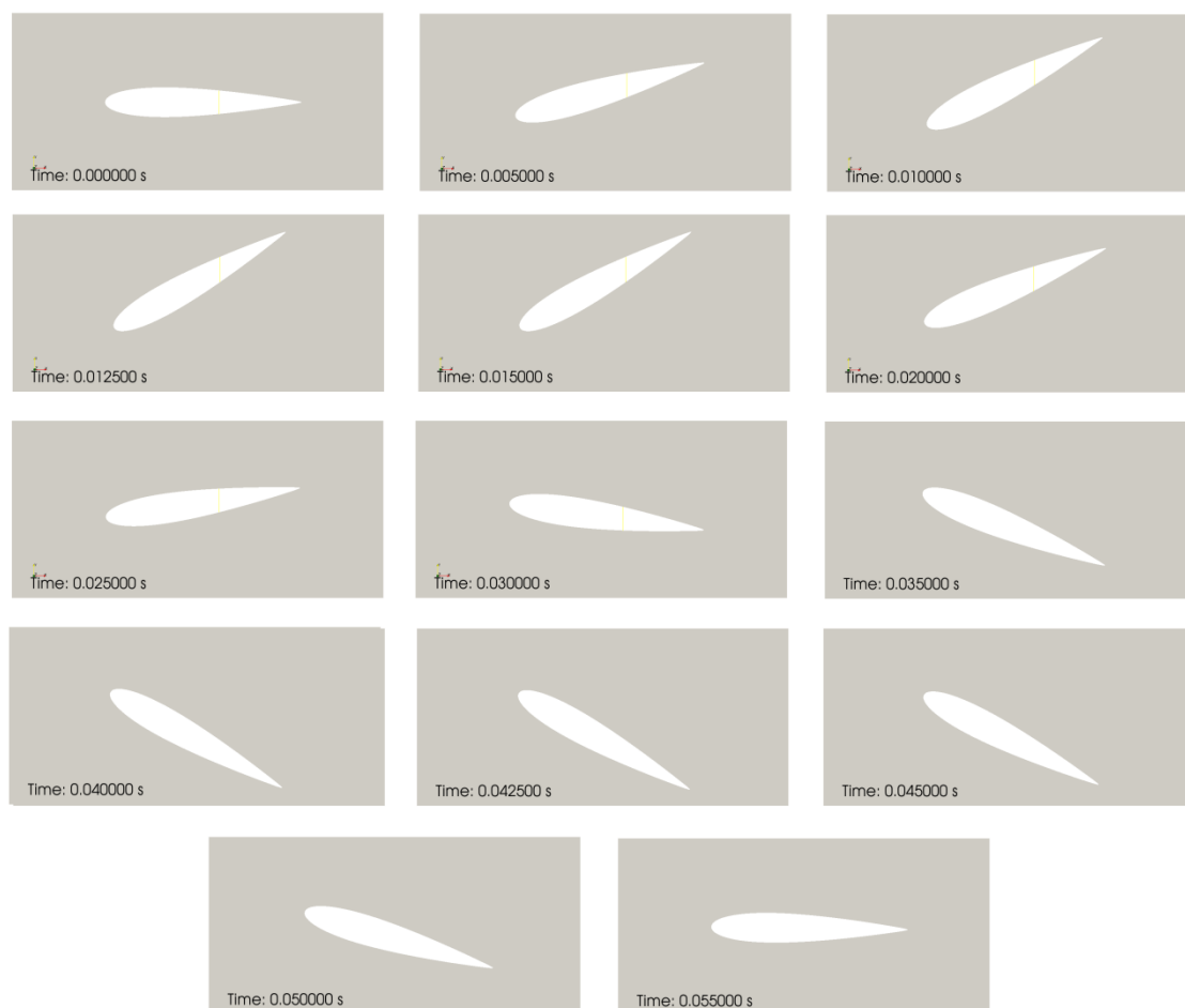
Obr. 8: Pohyb leteckého profilu v průběhu jedné periody (55 ms) s maximální výchylkou v rotaci 29,5^\circ a posuvem 2,1 mm.
