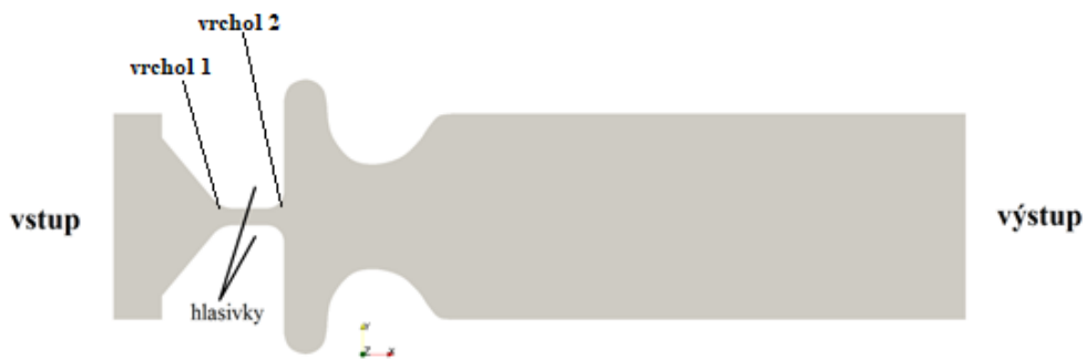
Obr. 20: 2D výpočetní oblast reprezentující zjednodušenou geometrii hlasivkového traktu.
