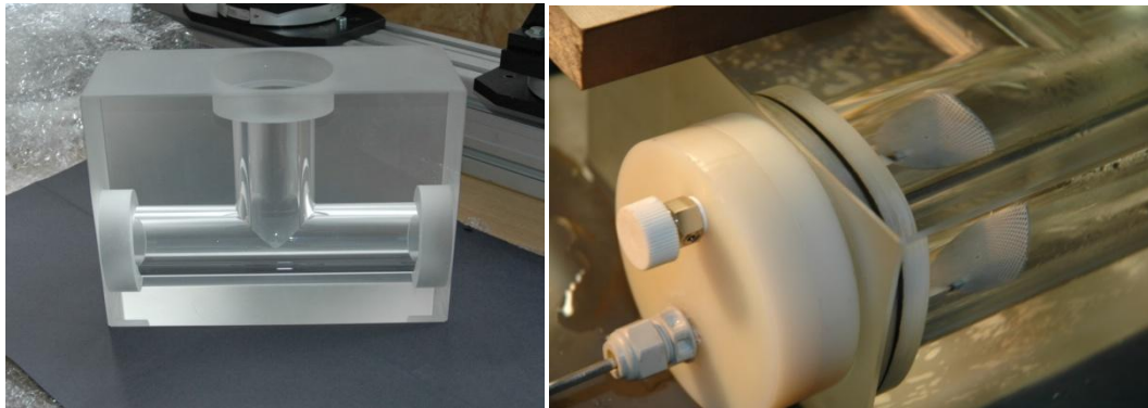
Obr. 33: Ilustrace rozvětvení tvaru T (vlevo) a detail na zkreslení kalibračního terčíku připevněného na speciálním uzávěru
